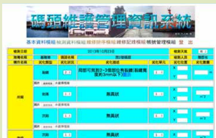
▲ 圖 52 碼頭經常巡查資料新增 - 以基隆港西 2 號碼頭為例 Figure52 Harbor frequent inspection data addition – Keelung Port No. 2 west bank
